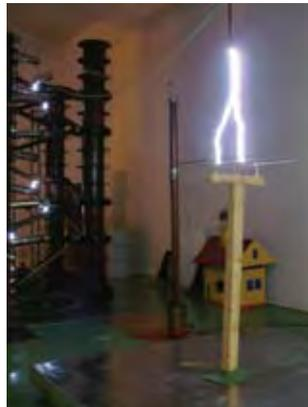
Имитирование атмосферных разрядов в модель возд. линии в Лаборатории высоких напряжений Galmar
