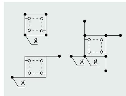
Рис. 11 Система заземления ЛЭП
