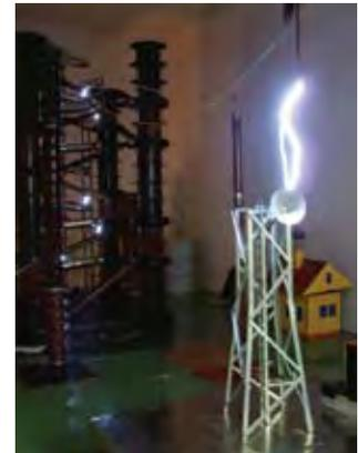
Имитирование атмосферных разрядов в модель башни GSM в Лаборатории высоких напряжений Galmar
