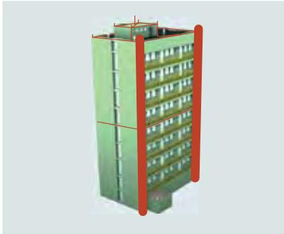
Рис. 4 Проектирование токоотводов для высокого жилого здания
