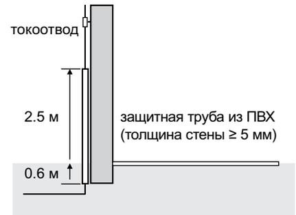
**тип Б** – взаимосвязанный стальной каркас в бетонном основании (присоединение к каркасу должно быть всегда доступным) или внешнее замкнутое кольцо заземления радиусом  $r$  не менее  $l_1$ , ( $r \geq l_1$ ). Если  $r < l_1$  необходимы дополнительные заземляющие электроды длиной  $l_r = l_1 - r$  или вертикальные электроды длиной  $l_v = 0.5 (l_1 - r)$ .
