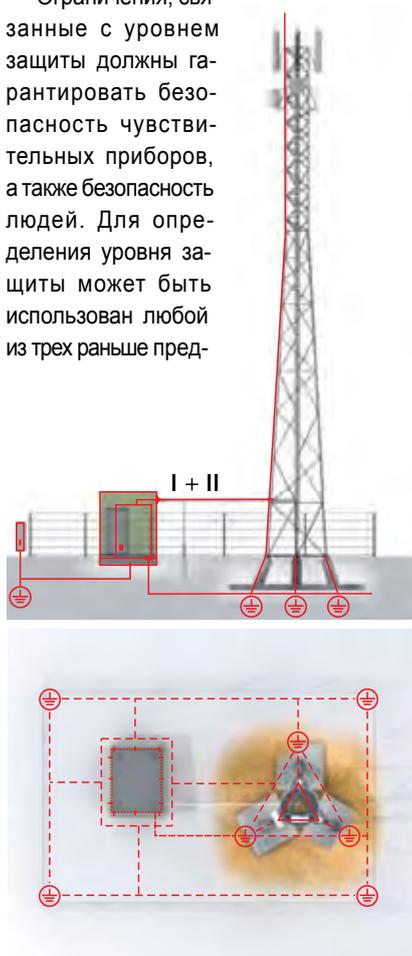
Рис. 13 Молниезащитная система металлических GSM башен
