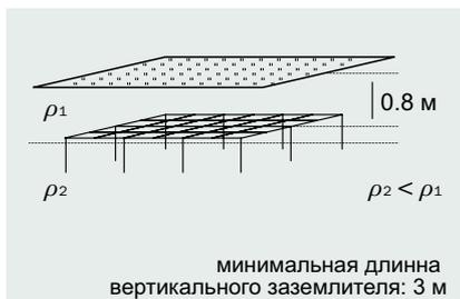
Рис. 9 Схема искусственного заземляющего устройства электрической подстанции
